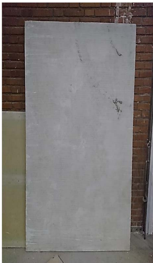
شکل ۱- پانل کامپوزیتی متشکل از پارچه سه بعدی شیشه، پر شده با ملات سیمانی
