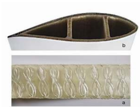
استفاده از پارچه سه‌بعدی در ساخت بدنه هواپیما
