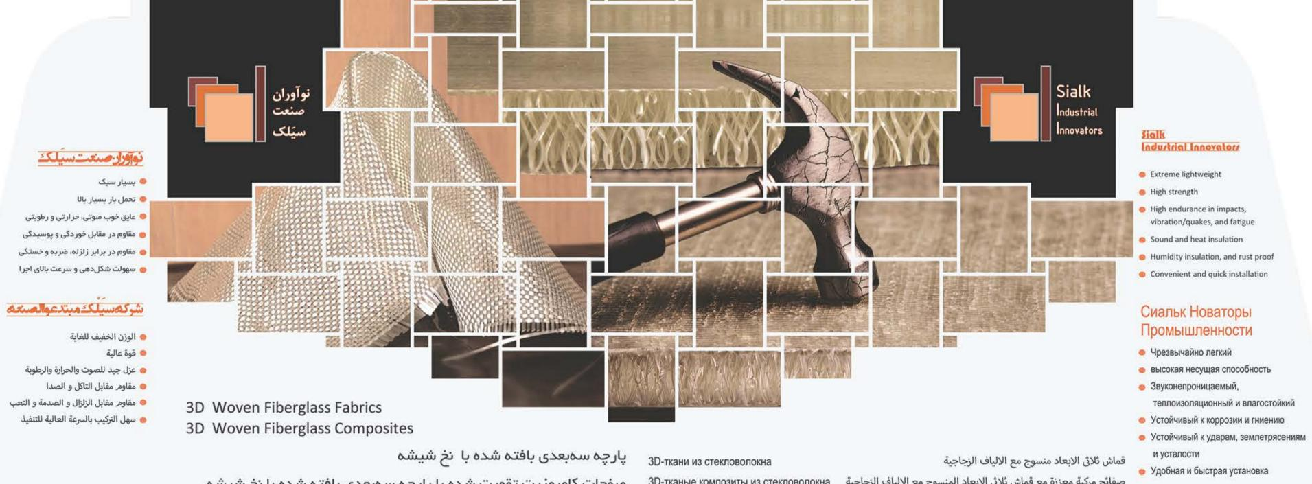
صفحات کامپوزیت تقویت شده با پارچه سمبعدی بافته شده با نخ شیشه
