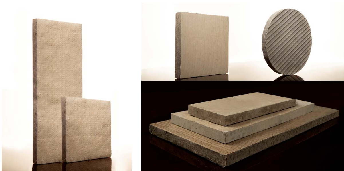
شکل ۷- پانل کامپوزیتی متشکل از پارچه سه بعدی شیشه، پر شده با ملات سیمانی
