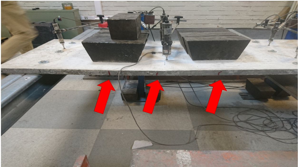
شکل ۴-۹- الگوی ترک‌های مؤین مشاهده شده در پایان بارگذاری
