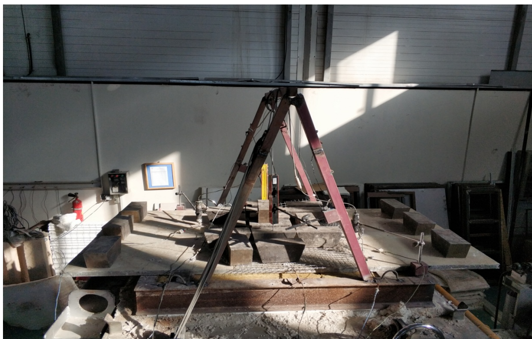
شکل ۴-۱۵- ابزارگذاری آزمایش و نحوه وزنه‌گذاری روی پانل
