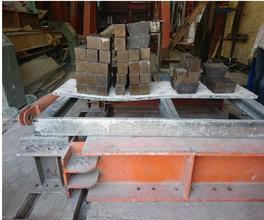
شکل ۴-۴- بارگذاری در انتهای آزمون (۵۹ وزنه در دهانه اصلی و ۱۶ وزنه در دهانه فرعی)
