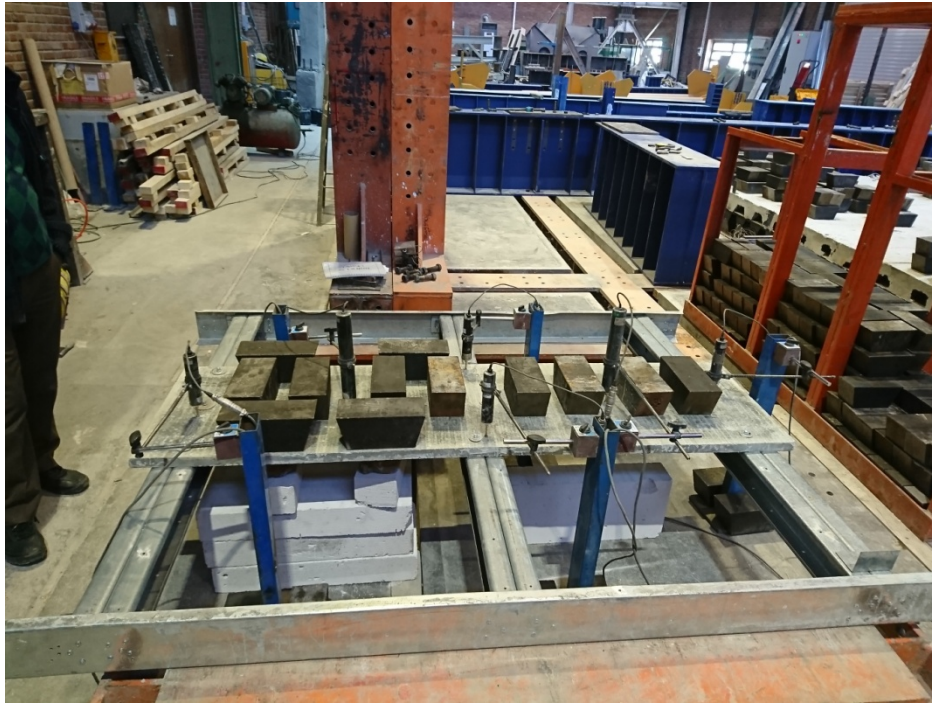
شکل ۲-۴- بارگذاری ۸ وزنه در دهانه هدف و ۴ وزنه در دهانه مجاور
