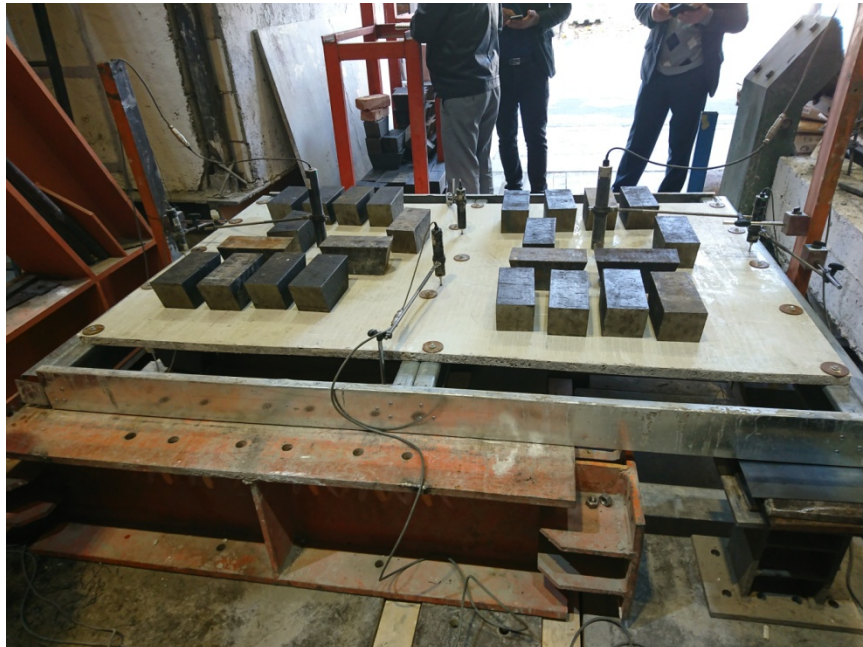
شکل ۱-۱۶- بارگذاری معادل بار مرده به صورت مساوی در هر دو دهانه (هر دهانه ۱۲ عدد وزنه)
