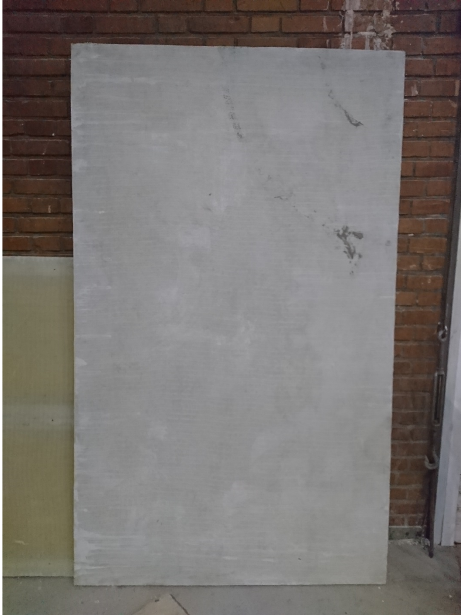
شکل ۱-۱- پانل کامپوزیتی متشکل از پارچه سه بعدی شیشه، پرشده با ملات سبک
