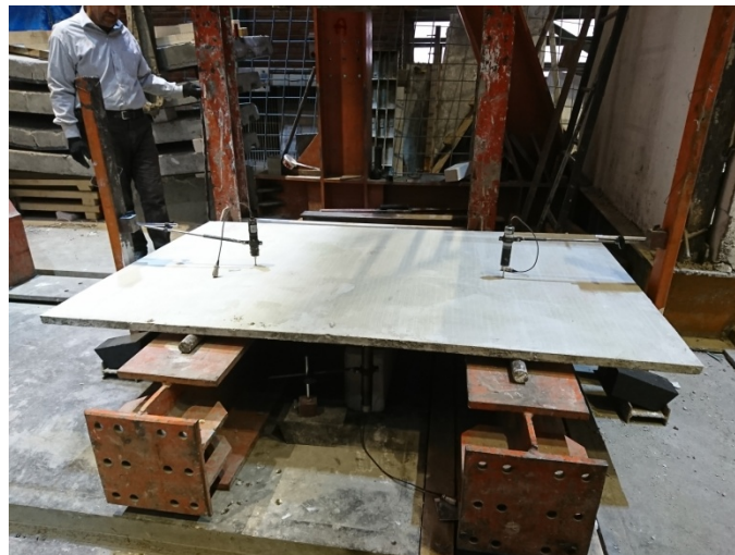
شکل ۹-۱- چگونگی ابزارگذاری آزمون بارگذاری تک دهانه شماره (۱)
