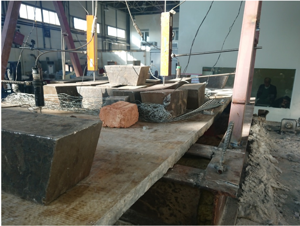
شکل ۴-۱۸- شرایط سقف در انتهای آزمایش آتش
