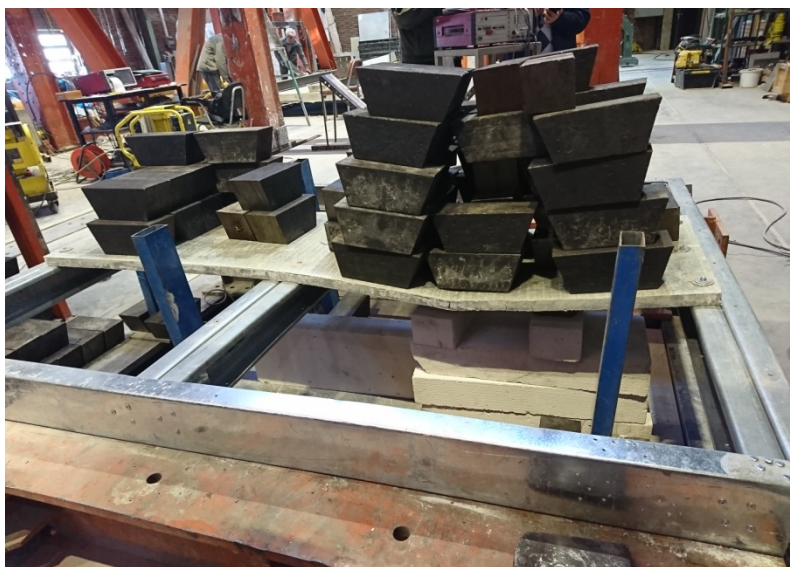
شکل ۲-۱۰- بارگذاری در انتهای آزمون (۴۸ وزنه در دهانه اصلی و ۱۵ وزنه در دهانه فرعی)
