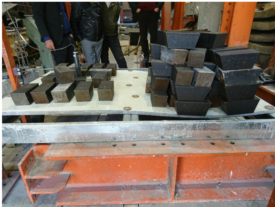
شکل ۱-۱۷- بارگذاری قبل از شکست پانل در دهانه اصلی (۹۵ وزنه در دهانه اصلی)
