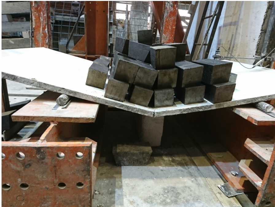
شکل ۱-۱۲- شکست پانل پس از تحمل ۵۸ وزنه معادل ۹۲۹٫۸ کیلوگرم
