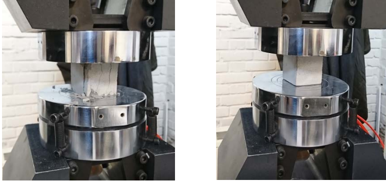
شکل ۳-۱- آزمون مقاومت فشاری پرکننده شماره ۳
