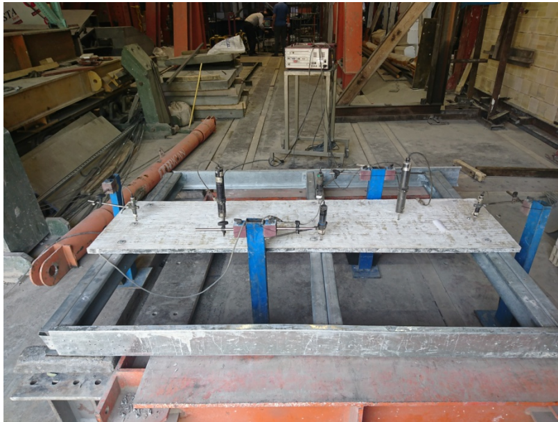
شکل ۴-۱- ابزارگذاری آزمون بارگذاری دو دهانه برای مصالح جدید (دهانه ۸۰ و ۱۰۰ سانتی‌متر)
