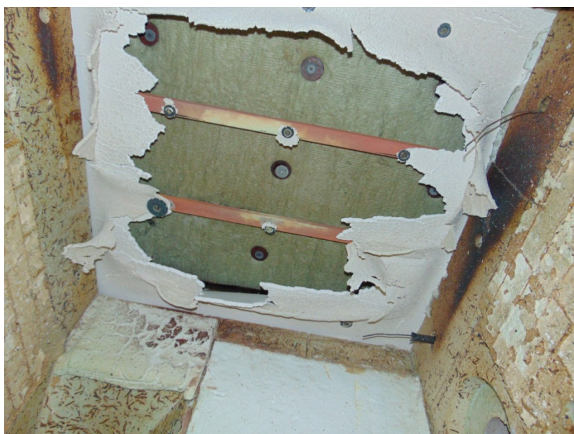
شکل ۴-۲۵- وضعیت نمونه بعد از تست بار مرده زنده همراه با آتش
