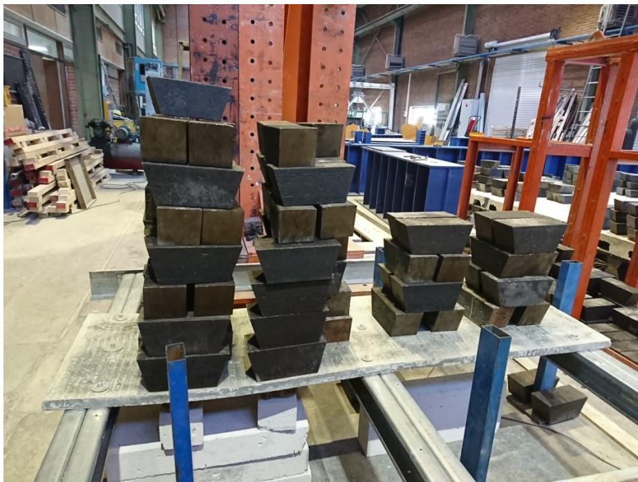
شکل ۲-۵- بارگذاری در انتهای آزمون (۵۷ وزنه در دهانه اصلی و ۱۶ وزنه در دهانه فرعی)
