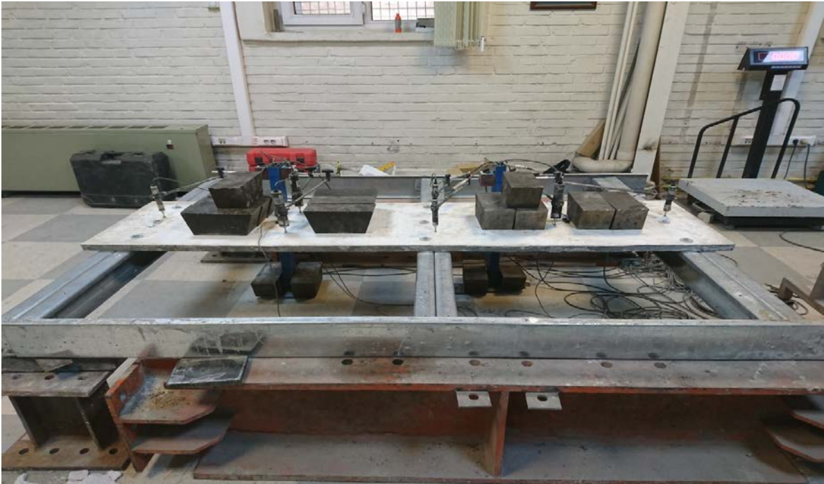
شکل ۴-۸- نمونه تحت آزمون خیز درازمدت
