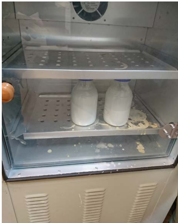
شکل ۱-۶- نمونه‌های قرار گرفته در محلول قلیایی
