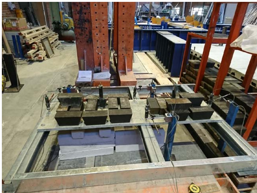
شکل ۲-۹- بارگذاری ۱۲ وزنه در دهانه هدف و ۹ وزنه در دهانه مجاور (□+□در هر دو دهانه)
