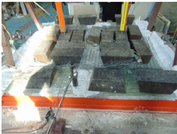
شکل ۴: ترموکوپل‌های نصب شده بر روی وجه غیردر معرض
